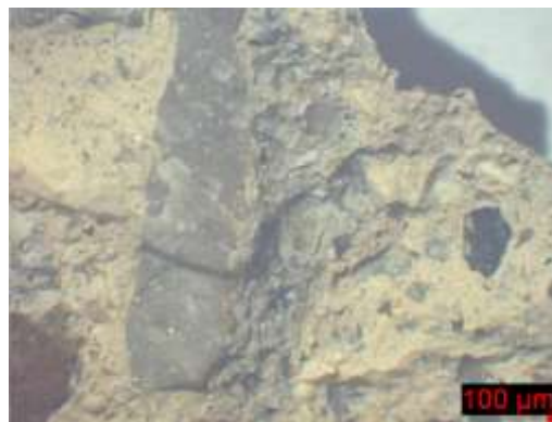
Σχήμα 5. Δομή σκυροδέματος με χρήση ανακυκλωμένων αδρανών (x8)
