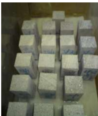
Εικόνα 7. Μέτρηση διείσδυσης χλώριο-ιόντων μέσω τριχοειδούς ανύψωσης
