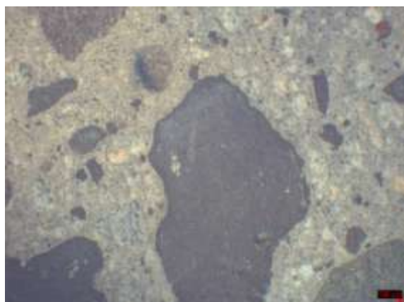
Εικόνα 7. Καλή συνάφεια πάστας – αδρανών σκωρίας (στερεοσκόπιο x8)
