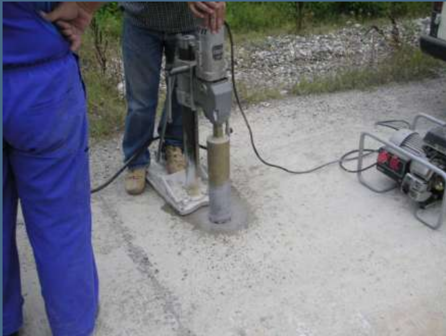
Εικόνα 3. Πυρηνοληψία σε θέση με καλά συμπυκνωμένο σκυρόδεμα
