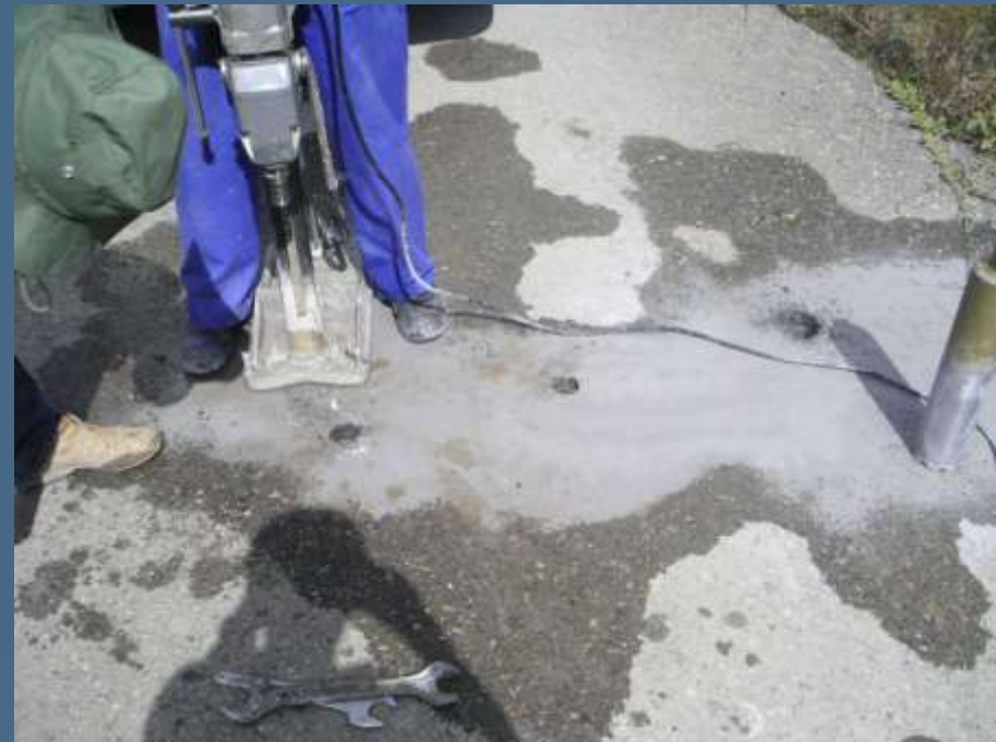
Εικόνα 4. Πυρηνοληψία σε θέση με ασφαλτική επικάλυψη
