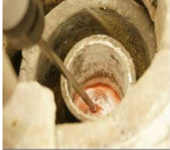
Εικόνα 3.β. Ανάμιξη τήγματος A356 Al – σωματιδίων ιπτάμενων τεφρών.
