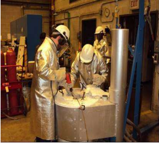
Εικόνα 3.α. Προσθήκη σωματιδίων ΙΤΚ στο υπό-ανάδευση τήγμα του κράματος A356 Al.
