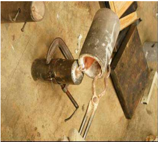
Εικόνα 3.γ. Χύτευση συνθέτου A356 Al – ΙΤΚ 10% σε κυλινδρικό καλούπι.
