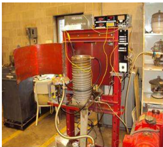
Εικόνα 2.α. Τροποποιημένος φούρνος για την παρασκευή των συνθέτων δοκιμίων με έγχυση υπό πίεση.
