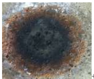
Σχ. 6. Εκτεθειμένη όψη μετά τη δοκιμή σε φλόγα
