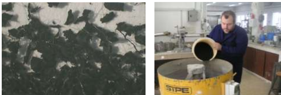
Εικόνα 1. Ανακυκλωμένο ελαστικό – μικροσκόπιο, σκυροδέτηση-
