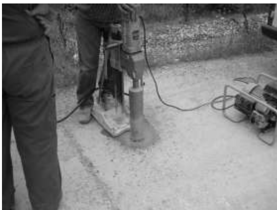
Εικόνα 3. Πυρηνοληψία σε θέση με καλά συμπυκνωμένο σκυρόδεμα
