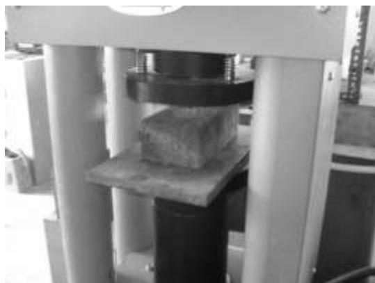
Εικόνα 10. Δοκιμή θλίψης σε κυβόλιθο οδοστρώσας
