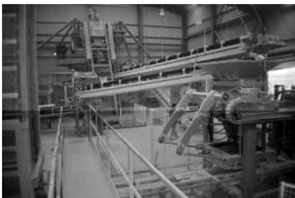
Εικόνα 5. Μηχανοποιημένο σύστημα παραγωγής Εικόνα 6. Σύστημα μορφοποίησης κυβολίθων
