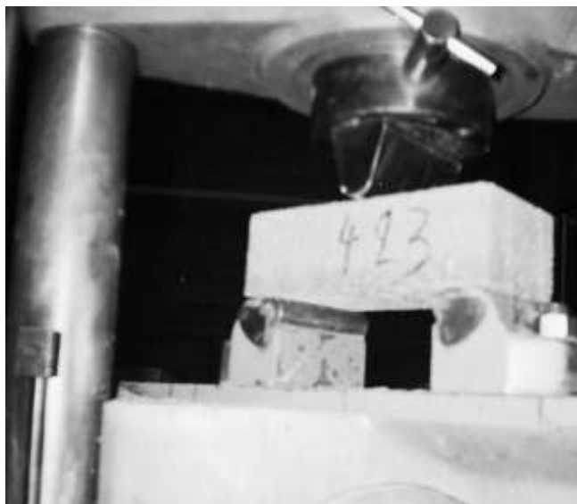
Εικόνα 12. Δοκιμή κάμψης σε κυβόλιθο
