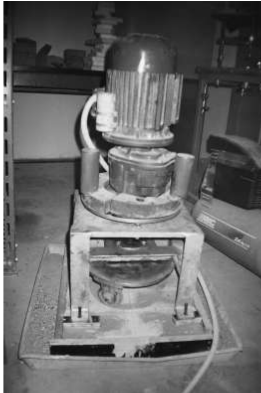
Εικόνα 14. Μηχανή απότριψης εν ώρα λειτουργίας
